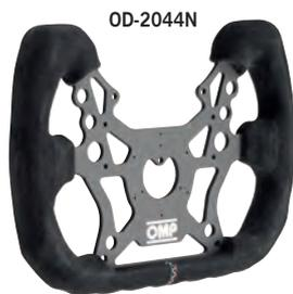
Vorbereitet zur Aufnahme verschiedener Displaysysteme, z.B. MoTec C125.
