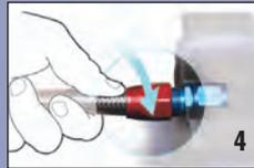
Nun das Einschraubstück in den Schraubstock einspannen, das Gewinde einölen (Achtung: Kein Öl in den Ringspalt des Schneideringes bringen!) und die Überwurfmutter mit Schlauch per Hand aufschrauben.
