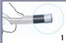
Schlauch an der Schnittstelle mit Klebeband umwickeln. Länge anzeichnen und mit feiner Säge trennen. Etwaige Rückstände von Schlauchende und -innenseite entfernen.
