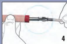
Die Edelstahlaußenhülle von der Teflonseele abheben. Am einfachsten verwenden Sie dazu unser spezielles Montagewerkzeug.
