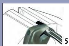
Die Überwurfmutter mit einem Schraubenschlüssel festziehen, bis sie den Sechskant des Anschlussstückes erreicht.
