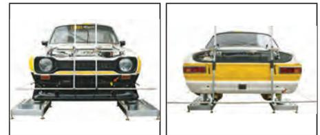
! Für die höchste Präzision kann das Schnur-Messgerät mit dem Hubstands-Vermessungsstand (siehe nächste Seite) verwendet werden.
