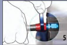
Überwurfmutter und Einschraubstück mit Maulschlüssel festziehen, während der Schlauch in der ursprünglichen Lage gehalten werden muss.
