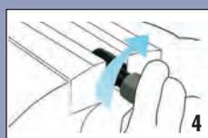
Den Schlauch fest auf das Gewinde drücken, während die Überwurfmutter per Hand aufgeschraubt wird. Die Überwurfmutter mit Schlauch sollte 3-4 Gewindegänge angeschraubt werden.
