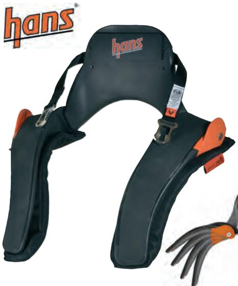
Das verstellbare HANS-System lässt sich mit wenigen Handgriffen in 5° Schritten zwischen 10° und 40° verstellen. Somit ist eine äußerst individuelle Anpassung an Sitzposition und Fahrerstatur möglich. Gefertigt aus verstärktem Kunststoff und mit Sliding Tethers für optimale Seitensicht ausgestattet. Gewicht: ab ca. 1060 g (in Größe Medium). Homologation: FIA 8858-2010.
