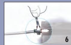
Nun das Einschraubstück in den Schraubstock einspannen, das Gewinde einölen (Achtung: Kein Öl in den Ringspalt des Schneideringes bringen!) und die Mutter mit Schlauch per Hand aufschrauben.
