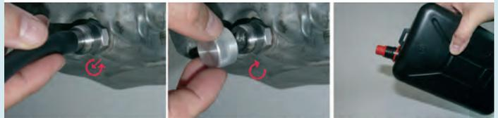
Schlauchanschluss mit halber Umdrehung entriegeln und abziehen.
