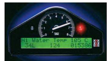
Die integrierte Schaltlampe informiert den Fahrer über das Erreichen der einstellbaren Schaltdrehzahl. Straßensysteme haben stattdessen eine Tankstandwarnlampe. Bei allen Displaysystemen besteht die Möglichkeit, eine externe Schaltlampe anzuschließen.
