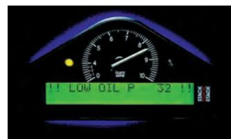
Das intelligente Alarmsystem überwacht für alle Motorparameter die einstellbaren Grenzwerte 20 mal pro Sekunde. Bei Über- bzw. Unterschreiten leuchtet eine integrierte Alarmlampe auf und auf dem Display erscheint eine entsprechende Warnmeldung.
