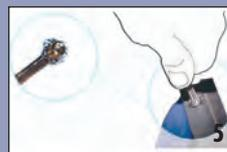
Die Dichtolive bis zum inneren Bund auf die Teflonseele aufschieben. Die Edelstahlmantelung befindet sich nun über der Olive. Überprüfen Sie nochmals, ob die Teflonseele am inneren Bund der Dichtolive anliegt.
