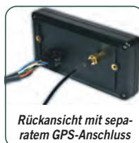
Rückansicht mit separatem GPS-Anschluss
