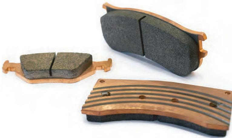
Es gibt 2 gänzlich unterschiedliche Arten von Motorsportbremsbelägen: bei herkömmlichen organischen Bremsbelägen wird ein aus verschiedenen organischen Harzkomponenten bestehender Bremsbelag auf eine Trägerplatte geklebt. Sintermetallbeläge unterscheiden sich davon deutlich, da der aus einem Mix aus unterschiedlichen pulverisierten Metallen bestehende Reibbelag unter Druck und einer Temperatur von 1.000°C mit einer verkupferten Trägerplatte verbunden wird.
