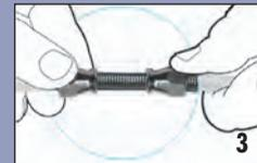
Die Muttern beider Anschlüsse wie abgebildet über den Schlauch schieben.
